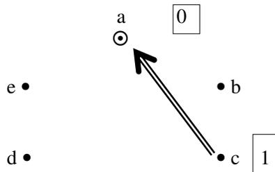
En c llegan arcos procedentes de a, b, d. Se coloca una cota de valor dos en b y en d pero no en a porque ya existía una en este vértice.
