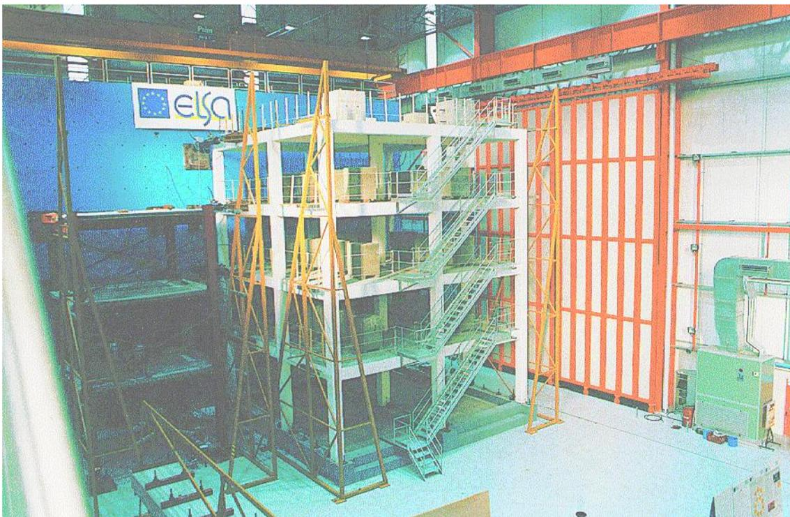
**Figura 4. Edificio de concreto armado ensayado en ELSA**
