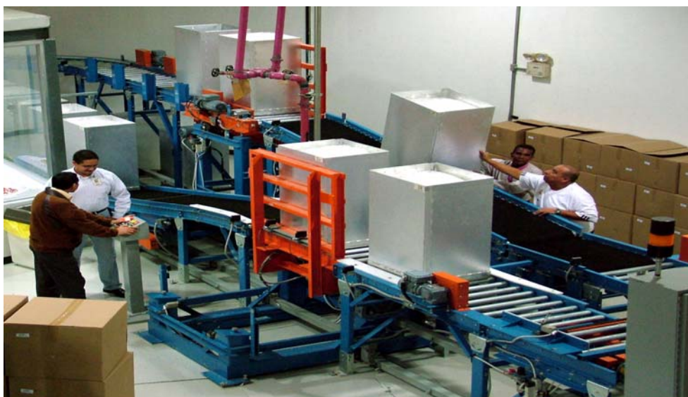
Planta Pegamma, preparación de los materiales a irradiar en la línea de montaje Departamento de Fotografía del IVIC
