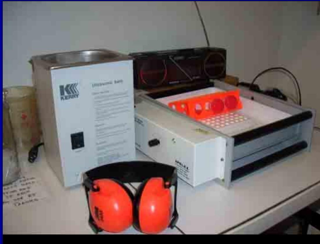
**Sonicador para romper células y agitador
