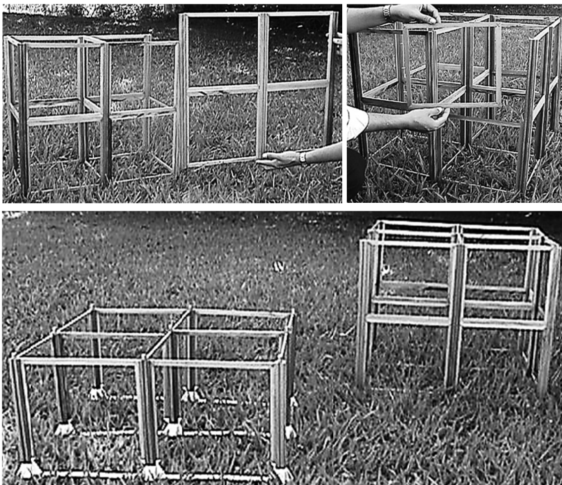
Figura 2. Diferentes fotos donde se muestra la maqueta del módulo estructural del sistema, pudiéndose apreciar sus elementos constitutivos y las distintas alturas que se pueden conseguir.
