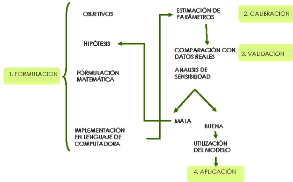
Figura 5. Esquema de los diferentes pasos en el proceso de modelización. (Adaptado de Haefner, 2005).
