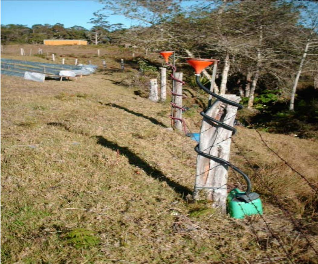
**Figura 5.** Pluviómetros de precipitación vertical instalados en el campo (Al frente).
