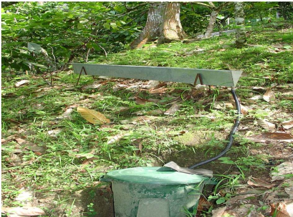
**Figuras 6 y 7.** Pluviómetros de precipitación neta instalados en el campo.
