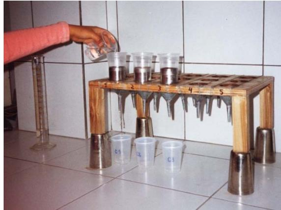
**Figura 11.** Método de permeámetro de carga constante para el cálculo de la conductividad hidráulica en condiciones de saturación.
