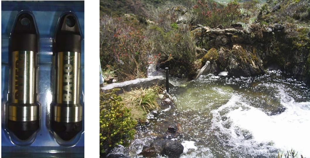
**Figura 12.** Sensores de caudal. Estación de caudal en la Microcuenca de la Quebrada Miguaguó en el Páramo de Mixteque, el limnígrafo (Diver) se encontraba dentro tubo negro localizado al lado del vertedero.
