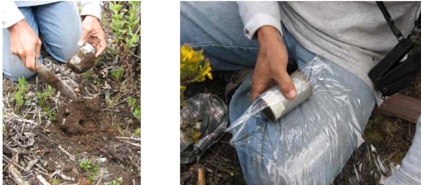
**Figura 10.** Método para la recolección de muestras de suelo inalterado para el cálculo de la densidad aparente, conductividad hidráulica en saturación y contenido de humedad en saturación.
