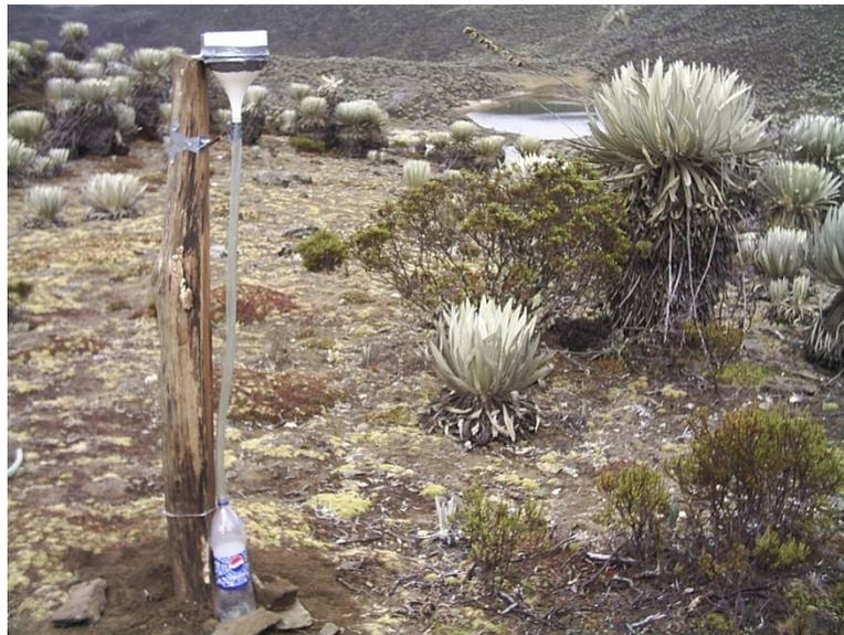
**Figura 7.** Pluviómetros artesanales instalados en la microcuenca.
