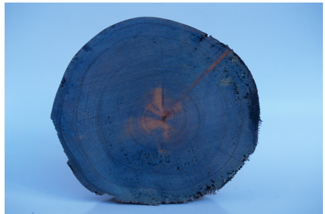
Figura 5. Penetración del preservante en el centro de una pieza de 10-12 cm de diámetro.
