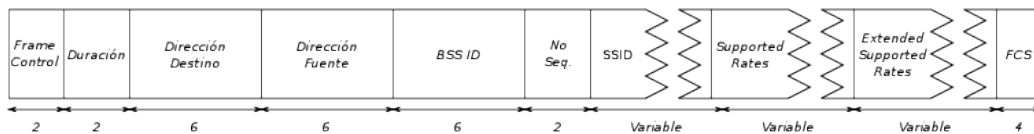
Figura 2.12: Estructura de una trama Probe Request
