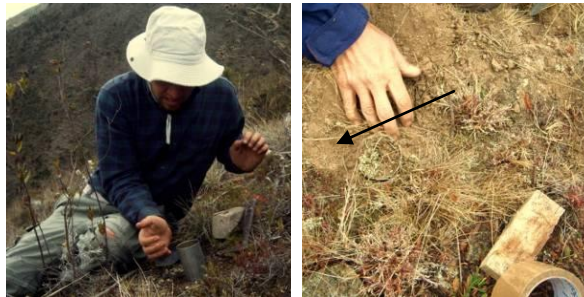
FIGURA 2.12. Recolección de muestras de suelo no alterado utilizando cilindros metálicos.
