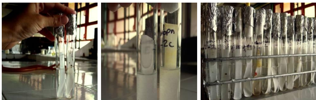
FIGURA 2.24. Tubos de ensayo con cultivo de microorganismos celulolíticos donde se utiliza como fuente de celulosa una tira de papel de filtro.
