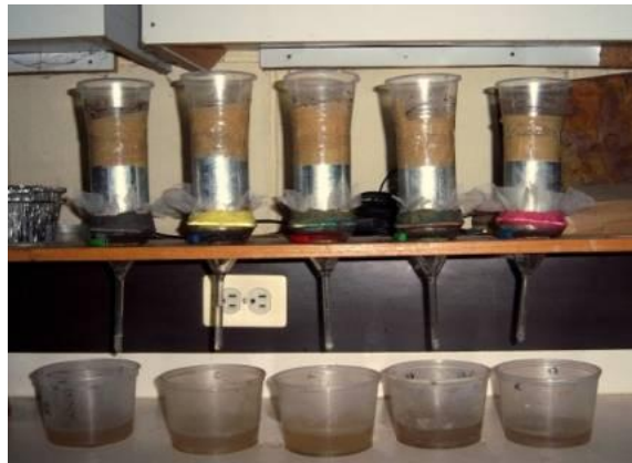
FIGURA 2.17. Dispositivo utilizado para la prueba de conductividad hidráulica, el cual incluye una estructura de madera con los cilindros apoyados sobre embudos, sobre los cilindros se pegaron vasos para mantener el volumen de agua y se utilizaron envases plásticos para la colecta del agua percolada.
