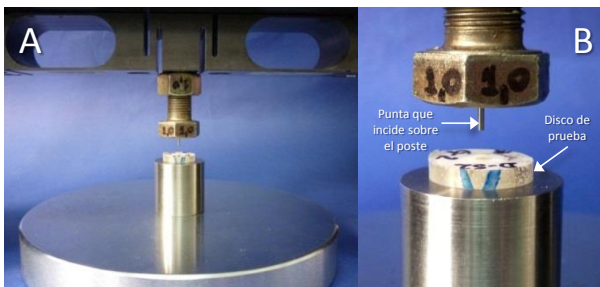
Figura 4. A, prueba de retención (push-out) mediante la máquina de fuerza universal Instron (IOII, Shimadzu autograph)®. B, disco de prueba de 2 mm de espesor.
