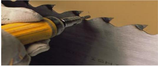
Figura 7. Técnica para eliminar las rebabas, las grietas en las gargantas (rugosidad) y aumentar la calidad final del afilado. Fuente: Sandvik, 1999
