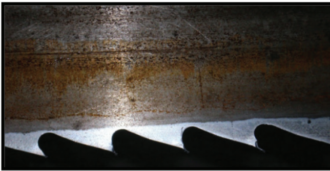
Figura 9. Cromado duro por electrólisis sobre Sierras de Cintas para el aserrado de la madera. (Fuente: Trejo et al. , 2013)
