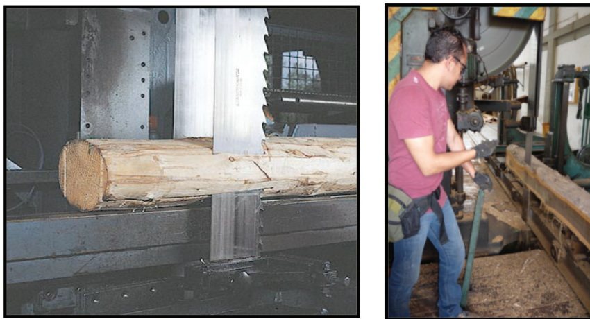
Figura 1. Aserrado de madera empleando una sierra de cinta doble vertical (izquierda) y sierra de cinta single (derecha). (Fuente: El Autor.)
