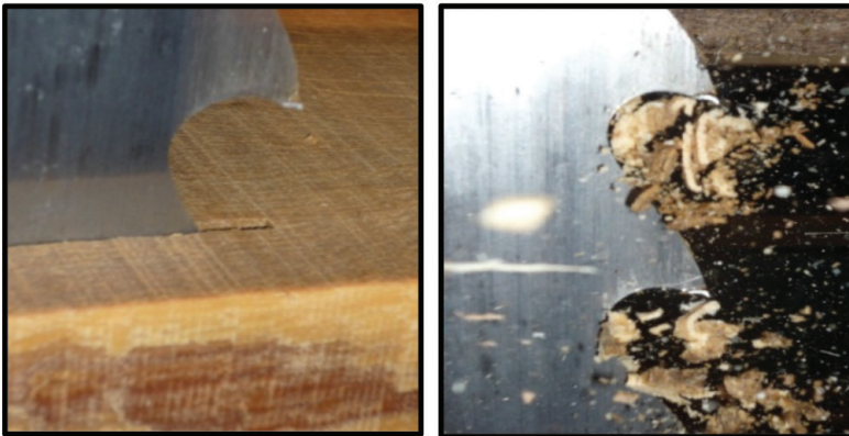
Figura 4. Izquierda: diente enfrentando el corte (altos impactos por la velocidad de la herramienta y la dureza de la madera). Derecha: dientes evacuando las virutas luego de realizar el corte (fricciones y temperatura producto de la mayor o menor abrasividad de la madera). (Fuente: El Autor).
