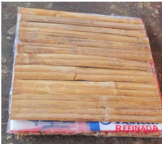
Figura 4. Tablero de tres capas conformado por tiras de caña bambú+cartón de leche+bambú+ PEED.
