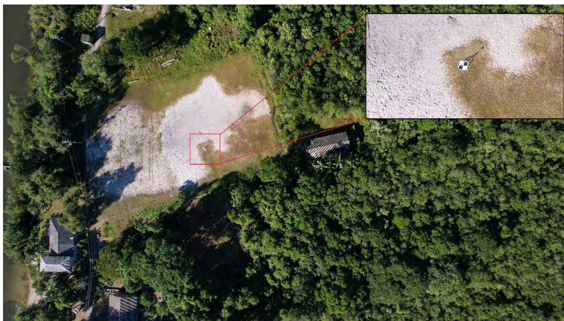
FIGURA 3. Exemplo de qualidade e detalhamento dos ortomosaicos e identificação de ponto de controle
