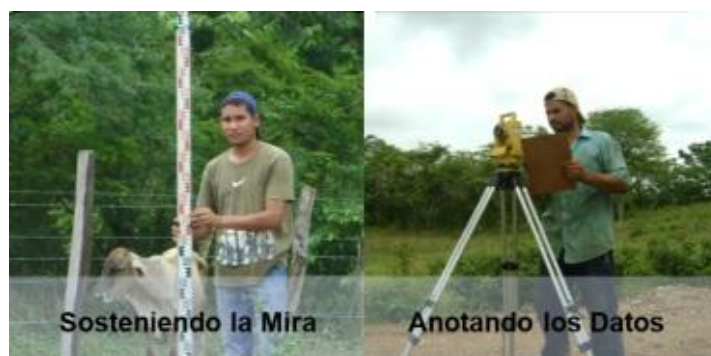
Figura 3. Levantamiento topográfico planialtimétrico, finca “Valle Hermoso”
