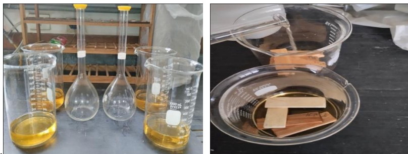
Figura 1. Evaluación de la madera. El ácido acético contenido en 4 vasos precipitados y preservado de probetas con ácido.
