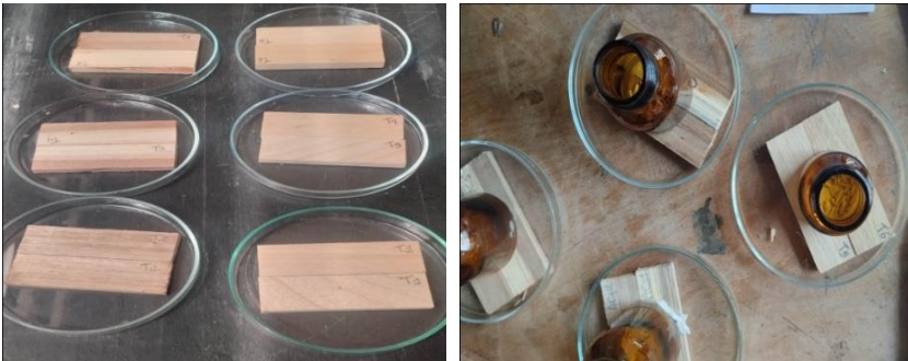
Figura 2. Fijación de probetas en la cápsula de Petri e introducción de 38 termitas obreras y 2 soldados en los cilindros color ámbar.
